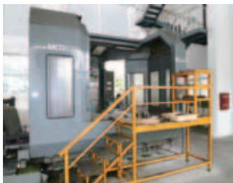
◀委託を受けて海外へ移設した設備移設横型マシニングセンター(Makino製)
